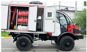
конструкторы «силанта» постарались превратить сельскохозяйственный автомобиль в универсальный. Имея один проектный модуль, машины могут по-разному комплектоваться, меняя свое назначение. Трансформация происходит за счет системы быстрого крепления верхнего навесного оборудования.
